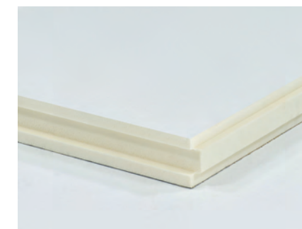
UTHERM Soffit PIR AW | \lambda 0,022 W/mK Velikost desek: 600 mm x 1200 mm
